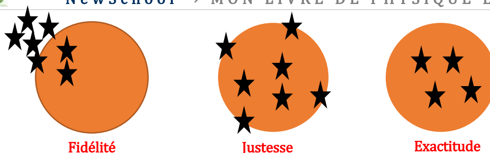
Figure 1.2 : Représentation symbolique de la fidélité, la justesse et l'exactitude en métrologie.
