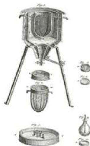
Figure 7.5 : Calorimètre à glace d'Antoine Lavoisier et Pierre Laplace en 1783
