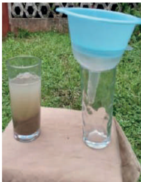
Document 8 : Filtration d'un mélange hétérogène
