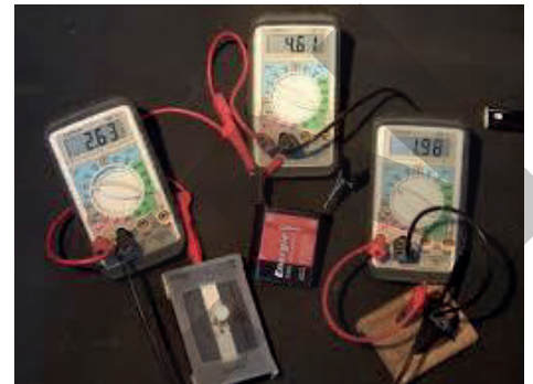
Document 5 : Tensions électriques aux bornes de lampes électriques en série
