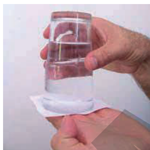
Document 2 : Mise en évidence de la pression atmosphérique
