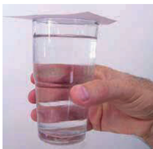
Document 2 : Mise en évidence de la pression atmosphérique
