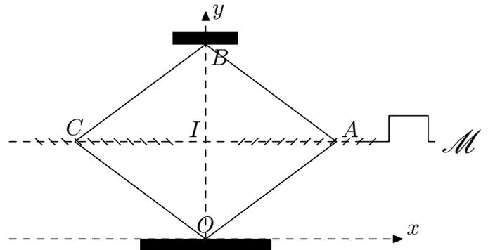
Celui-ci est constitué d'un losange déformable  $OABC$ , le point  $O$  étant le point d'appui sur le sol et le point  $B$  étant le point par lequel la voiture est soulevée.
